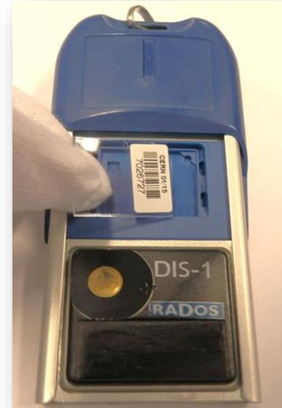
Mise en place des dosimètres dans le DIS
