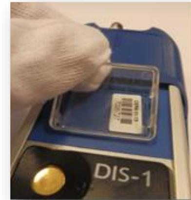
Mise en place de la fenêtre de protection
